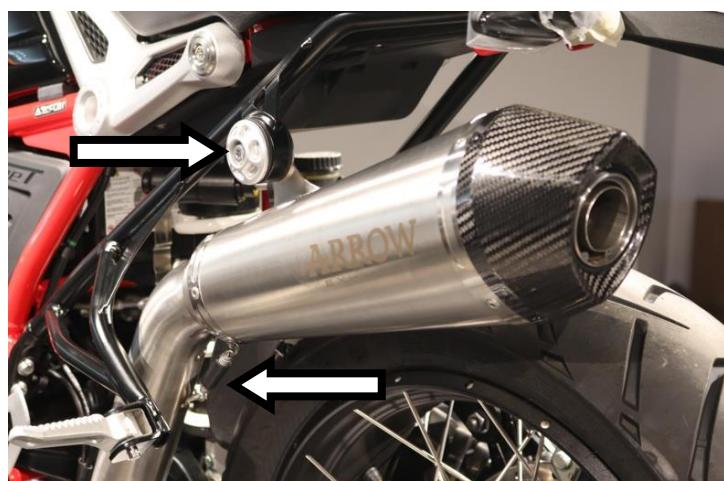
**IT** · Innestare il terminale X-Kone, serrarlo nel lato interno della pedana ed ancorare la molla
