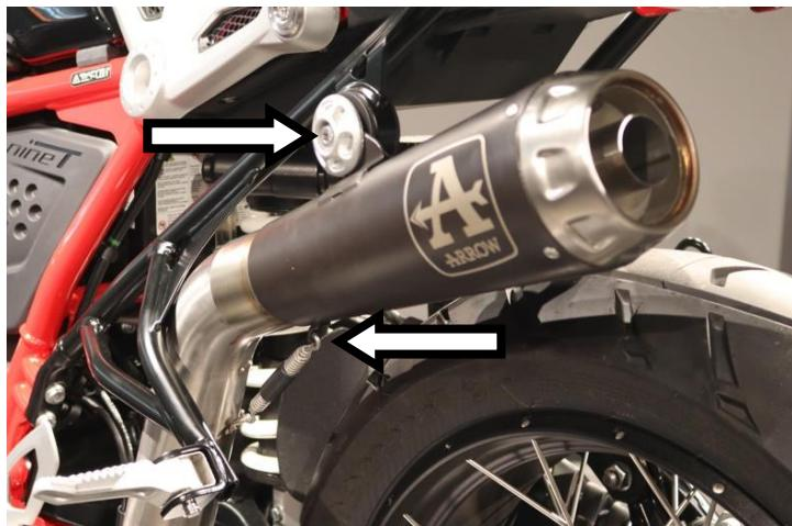
**IT** · Innestare il terminale Pro-Race, serrarlo nel lato esterno della pedana ed ancorare la molla (utilizzare nel lato interno della pedana la rondella ø46mm fornita)
