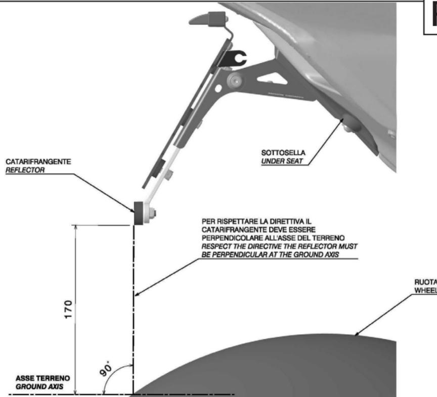
**ATTENZIONE:** REGOLARE LA DISTANZA TRA IL CATARIFRANGENTE E LA RUOTA POSTERIORE PER EVITARE POSSIBILI CONTATTI TRA LORO, DURANTE UN ESTREMO AFFONDAMENTO DELLA SOSPENSIONE. IL CATARIFRANGENTE DEVE ESSERE POSIZIONATO PIU' VICINO POSSIBILE ALLA PARTE INFERIORE DELLA TARGA.
