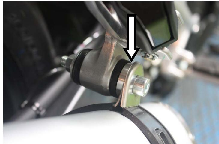
**IT** · Solo per terminali RACE TECH: Serrare il terminale alla pedana mediate fascetta interponendo lo spessore fornito
