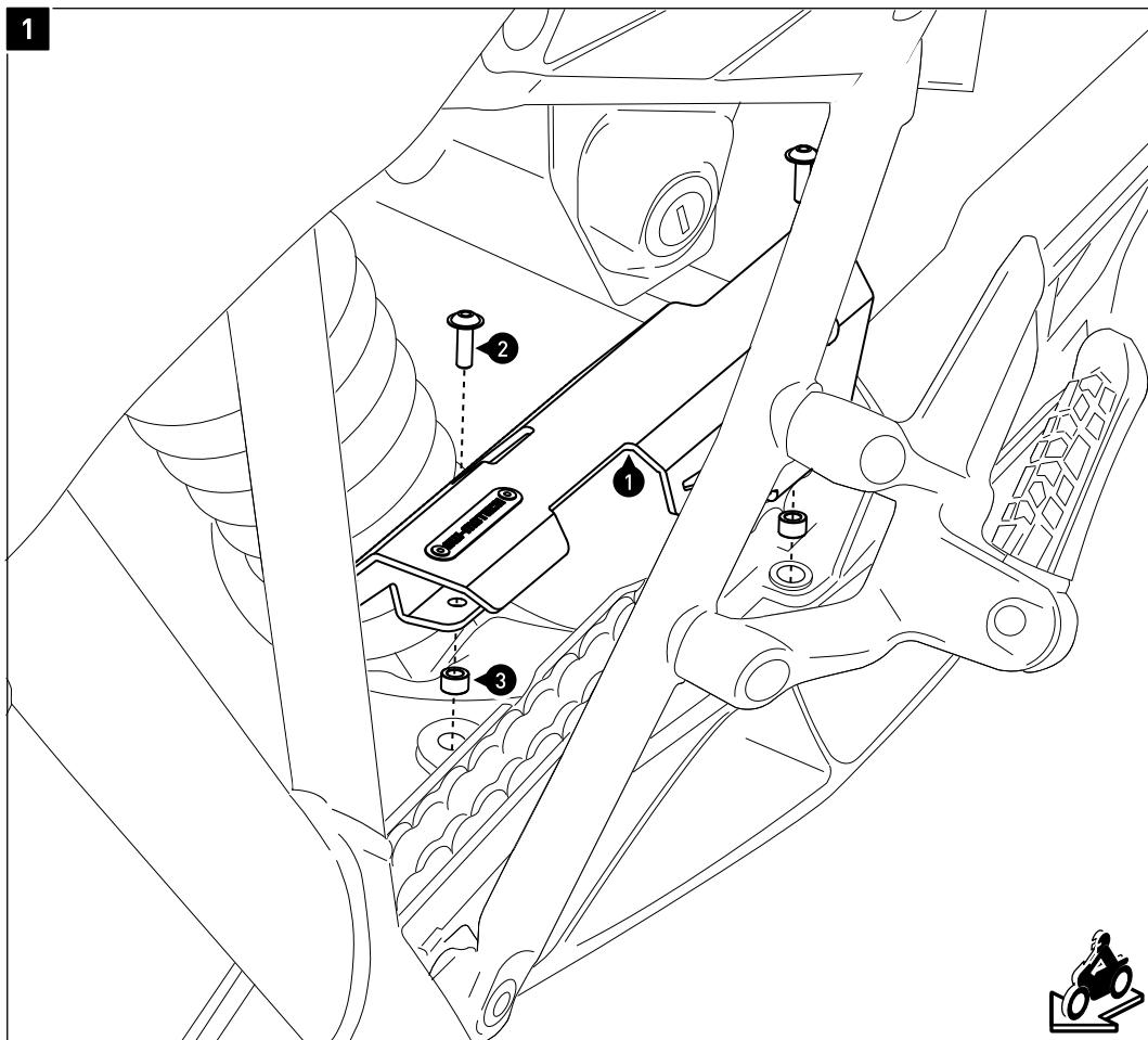
Entfernen Sie die orginalen Schrauben von den Anbaupunkten. Verschrauben Sie den Kettenschutz (1) am Fahrzeug, wie in der Zeichnung gezeigt.
